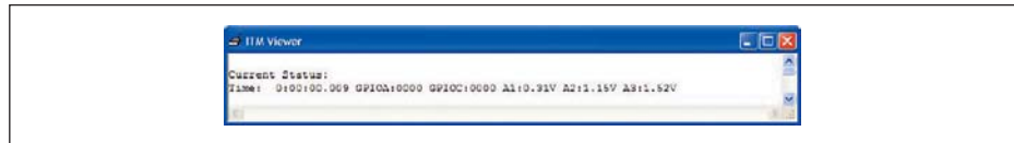
Рис. 6. Отладка "printf-style" с использованием ITM-регистров
